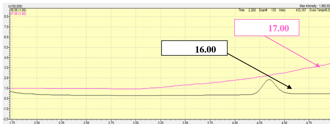
Rys. 29. Chromatogram próbki gazowej po procesie fotokonwersji (w trybie SIM dla 16 i 17 amu)
