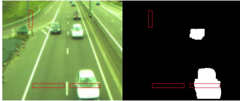
Rys. 3.15 Zliczanie pojazdów za pomocą wirtualnej bramki [154]
