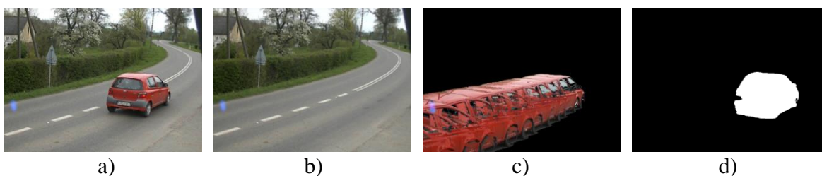
Rys. 3.4 Przykład działania algorytmu odejmowania tła z wykorzystaniem sumy ważonych rozkładów gaussowskich a) oryginalna ramka obrazu, b) wartości średnie rozkładu o największej wadze, c) wartości średnie następnego w kolejności rozkładu, nie zaliczanego w tym momencie do modelu tła, d) wykryte piksele należące do obiektu ruchomego
