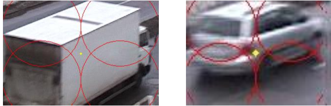
Rys. 5.8 Środek ciężkości maski pojazdu (żółty punkt) oraz położenie (i rozmiar) czterech punktów charakterystycznych (czerwone okręgi)
