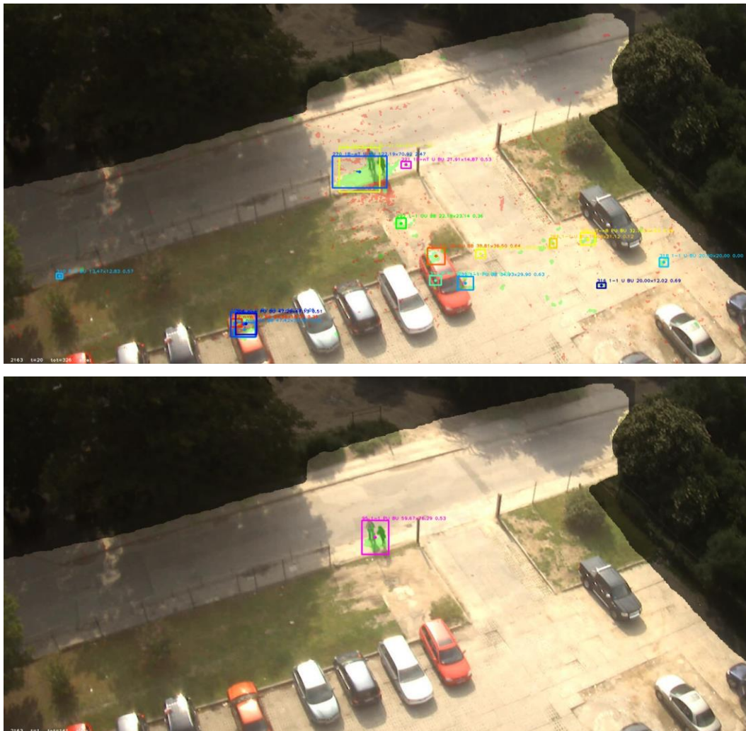
Rys. 4.8 Przykładowa ramka obrazu z nagrania O-S, analizowana algorytmem GMM (u góry) i GMM-Mod (u dołu). Zielone obszary oznaczają wykryte piksele należące do ruchomych obiektów (TP i FP), czerwone – wykryty cień. Dodatkowo kolorowymi prostokątami oznaczono wszystkie wykryte obiekty spełniające kryterium wielkości
