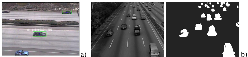
Rys. 3.8 W zależności od orientacji kamery względem pojazdów, wymiary prostokąta opisanego na masce pojazdu mogą oznaczać a) wysokość i długość pojazdu [177] lub b) szerokość oraz kombinację wysokości i długości pojazdu [191]
