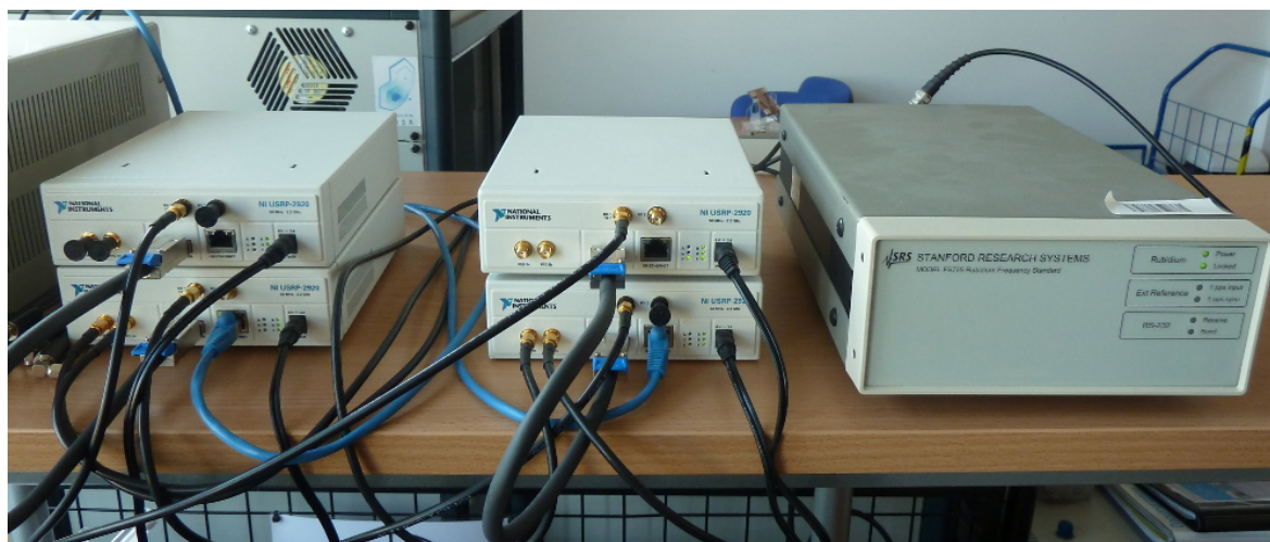
Rysunek 5.4: Cztery urządzenia USRP i rubidowy wzorzec częstotliwości
