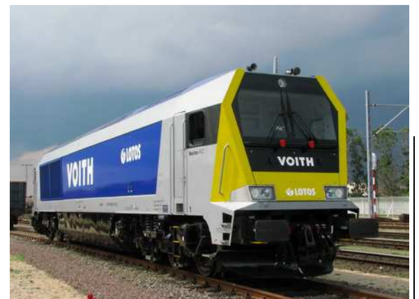
Rys. 1.12. Voith Maxima 40CC [85] Rodzaj przekładni: hydrokinetyczna Moc silnika spalinowego 3600 kW Prędkość maksymalna 120 km/h
