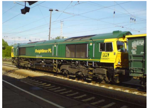
Rys. 1.10. EMD Class 66 [88] Rodzaj przekładni: elektryczna AC/DC Moc silnika spalinowego 2,420 kW Prędkość maksymalna 105 km/h
