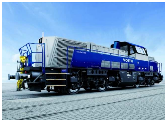
Rys. 1.8. Voith Gravita 10CC [85] Rodzaj przekładni: hydrokinetyczna Moc silnika spalinowego: 1200 kW Prędkość maksymalna: 100 km/h
