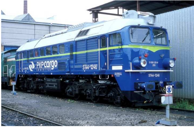
Rys. 1.9. ST44 [30] Rodzaj przekładni: elektryczna DC/DC Moc silnika spalinowego 1470 kW Prędkość maksymalna 100 km/h
