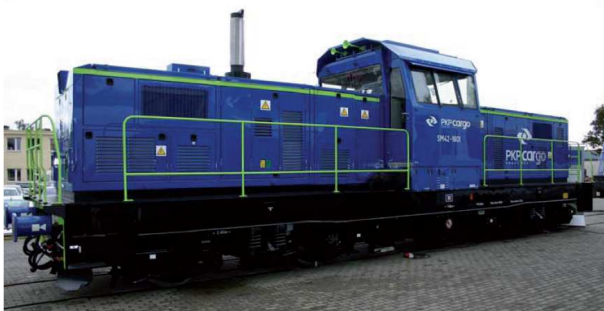
Rys. 1.7. SM42 6Dk [15] Rodzaj przekładni: elektryczna AC/DC Moc silnika spalinowego: 2x403 kW Prędkość maksymalna: 90 km/h
