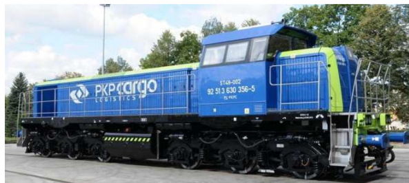
Rys. 1.6. ST48 16D [67] Rodzaj przekładni: elektryczna DC/DC Moc silnika spalinowego: 880 kW Prędkość maksymalna: 90 km/h
