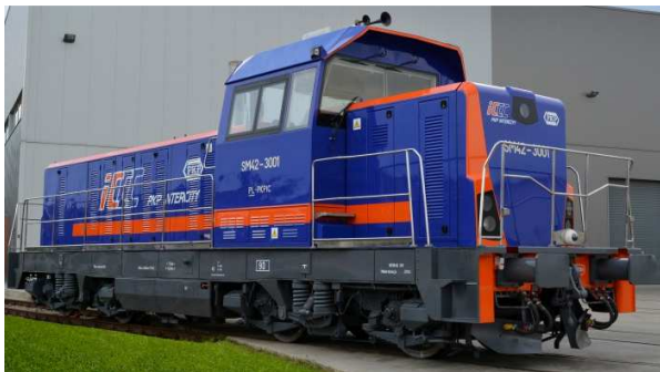
Rys. 1.5. SM42 18D [67] Rodzaj przekładni: elektryczna AC/DC Moc silnika spalinowego: 563 kW Prędkość maksymalna: 90 km/h
