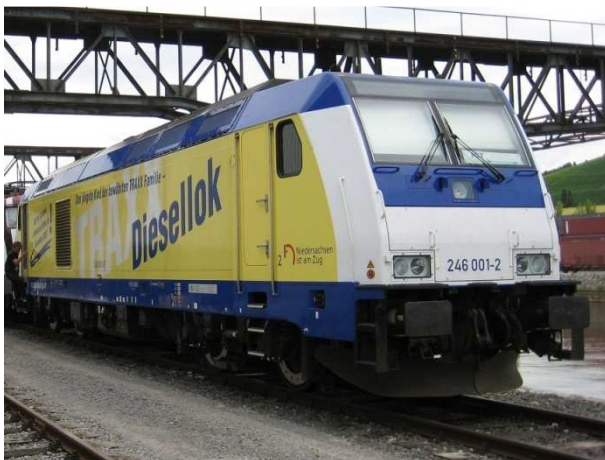
Rys. 1.11. Bombardier Traxx F140 DE [88] Rodzaj przekładni: elektryczna AC/AC Moc silnika spalinowego 2,200 kW Prędkość maksymalna 140 km/h
