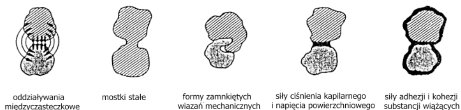
Ryc. 14. Interpretacja graficzna mechanizmów wiązania ziaren proszku lub granulatu w procesie kompaktacji [30].
