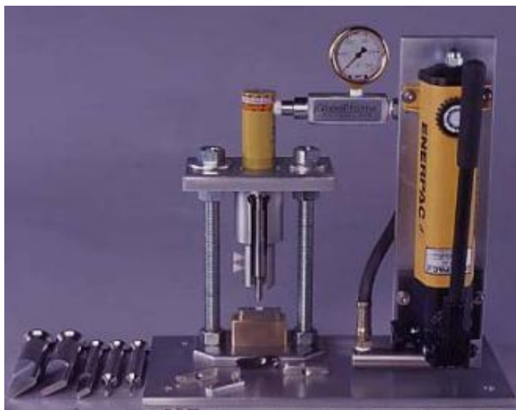
Ryc. 5. Prasa hydrauliczna z możliwością użycia stempli tabletkarki rotacyjnej [19].
