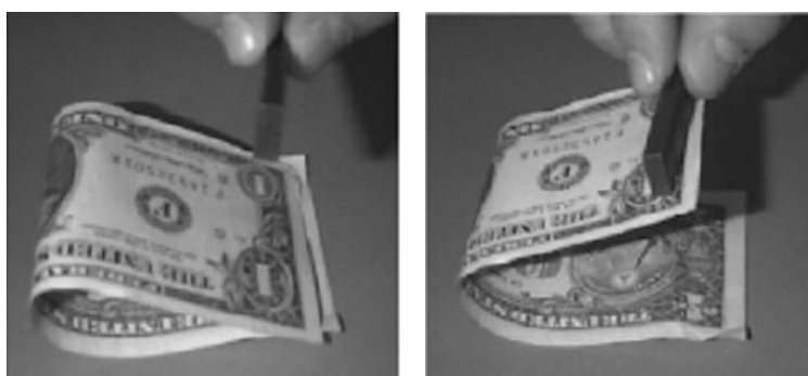
Rys. 3.18. Działanie magnesu na banknot drukowany farbą zawierającą nanocząstki magnetyczne. Zaadaptowane za zgodą z [9]. Copyright 1999, American Chemical Society
