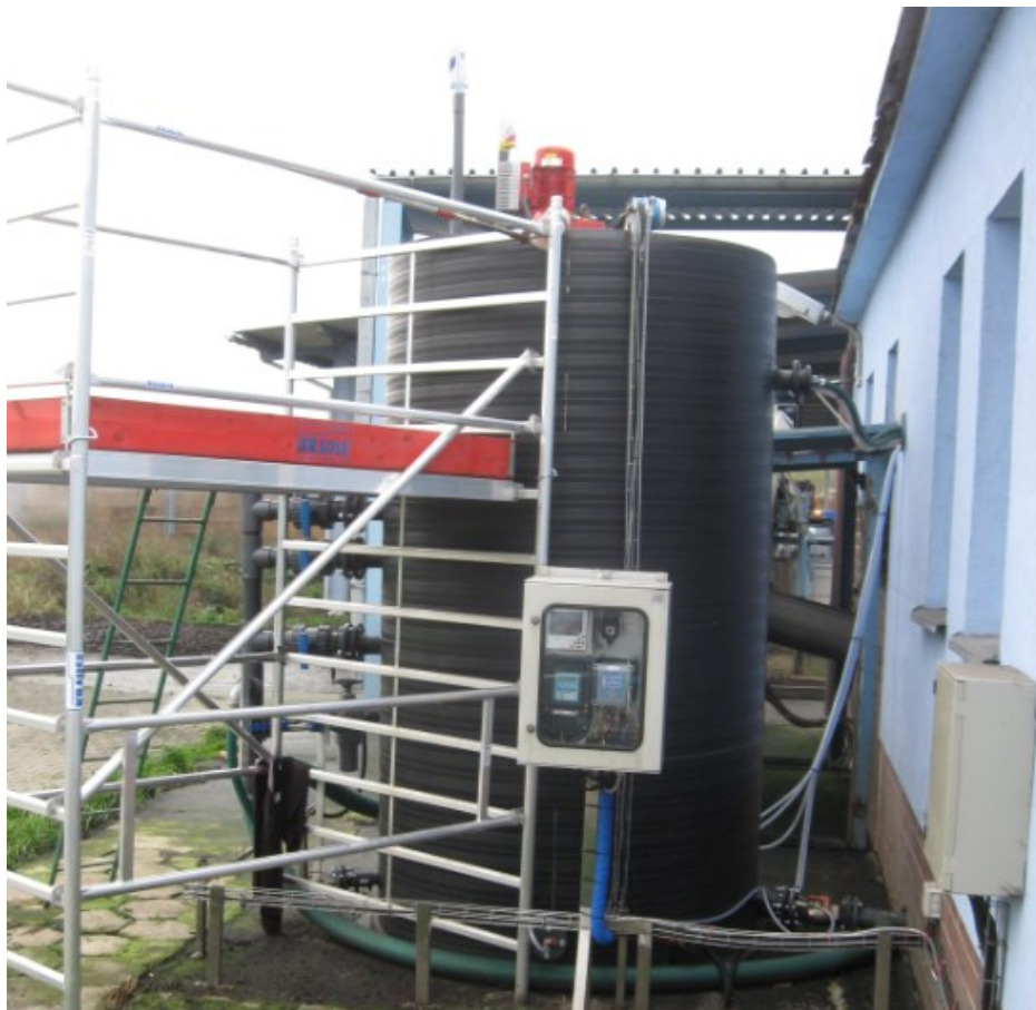
Rys. 3.4. Reaktor pilotowy SBR zlokalizowany w oczyszczalni ścieków Słupsk o pojemności 6 m 3 : (a) schemat technologiczny, (b) widok rzeczywisty
