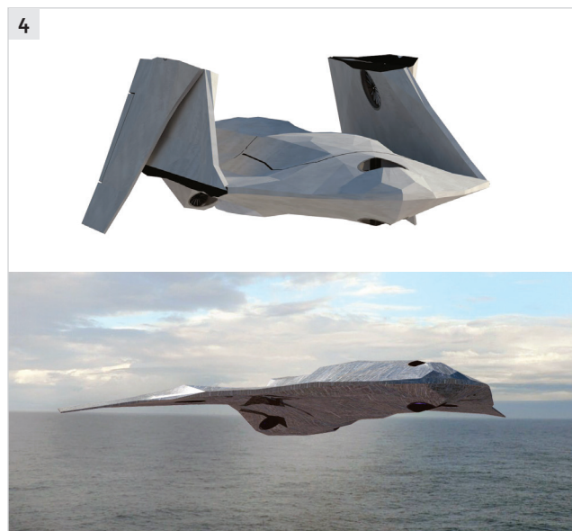
Rys. 4. Widok obiektu trzystanowego, w wersji koncepcyjnej, mogącego się poruszać pod wodą, na powierzchni wody i tuż nad jej powierzchnią
