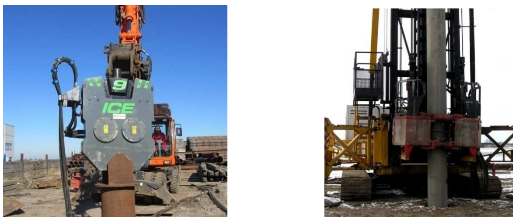
Fot. 2.4. Głowica wibracyjna i wibrator pierścieniowy [57].
