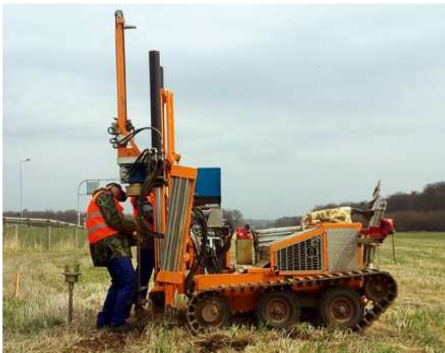
Fot. 3.5. Sonda statyczna [58].
