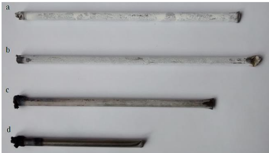
Rys. 9.36. Widok rurek oraz wytworzonej na powierzchni grzejnej warstwy na rurce o średnicy 5 mm podczas wrzenia nanocieczy \text{Al}_2\text{O}_3 o koncentracjach 1% (a), 0,1% (b) i 0,01% (c) w porównaniu do rurki użytej podczas eksperymentu wrzenia wody (d)
