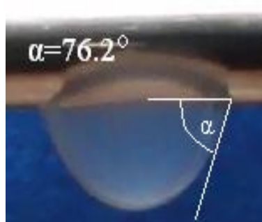
Rys. 8.4. Zdjęcie oraz schemat pomiaru kąta zwilżania nanocieczi woda- \text{Al}_2\text{O}_3 o koncentracji 0,01%
