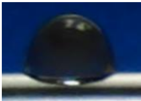
Rys. 9.25. Kropla osadzona oraz podwieszona nanocieczki woda-Cu na rurce stalowej o średnicy 3 mm
