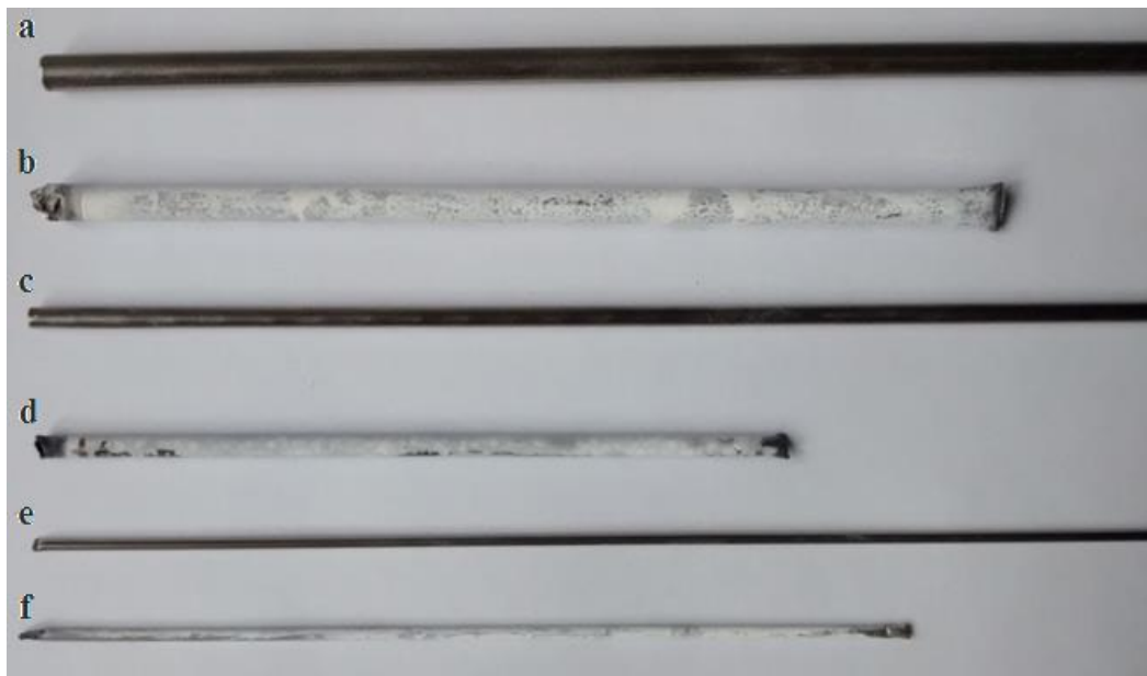
Rys. 9.35. Widok rurek oraz wytworzonej na powierzchni grzejnej warstwy na wszystkich badanych rurkach: 5 mm, 3 mm oraz 1,6 mm odpowiednio przed (a, c i e) i po eksperymencie (b, d, f)
