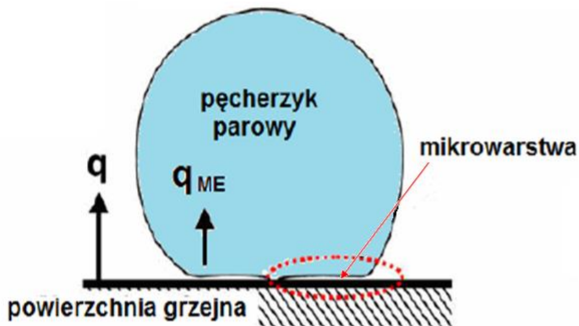
Rys. 9.50. Proces tworzenia nanowarstwy na powierzchni grzejnej [54]
