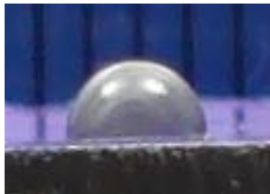
Rys. 9.24. Wpływ rodzaju nanocząstek na wartość kąta zwilżania nanocieczki a) woda- \text{Al}_2\text{O}_3 oraz b) woda-Cu o koncentracji masowej cząstek wynoszącej 1%
