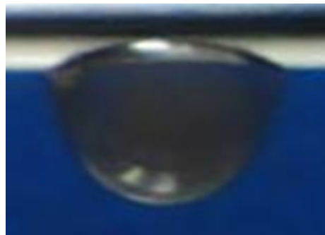
Rys. 9.25. Kropla osadzona oraz podwieszona nanocieczki woda-Cu na rurce stalowej o średnicy 3 mm
