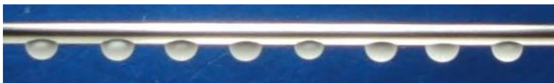
Rys. 8.3. Zdjęcie kropli wiszących nanocieczy woda-TiO 2 na rurce stalowej o średnicy 3 mm
