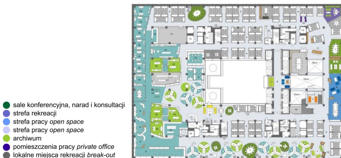
il.25. Organizacja przestrzenna biura typu business club . Biuro firmy konsultacyjnej JWT, Nowy Jork, 2008, proj. C.Wilkinson Architects + DEGW, źródło: http://www.archdaily/182354/jwt-headquarters-clive-wilkinson-architects-plan , [dostęp: 24.08.2015].
