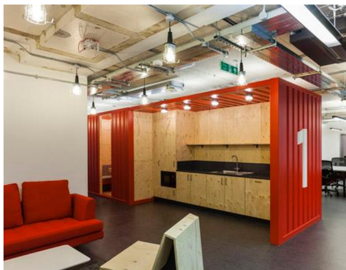
il.75. Stalowe używane i odzyskane kontenery towarowe morskie zaadaptowane we wnętrzu biurowym jako struktury aneksu kuchennego, Google Campus Londyn, proj. Jump Studios, 2012, fot., źródło: http://www.dezeen.com/2012/05/01/google-campus-by-jump-studios/ , [dostęp: 05.09.2014]
