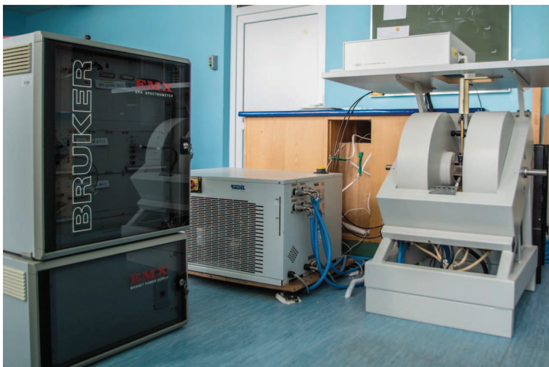
Rys. 12 Spektrometr Bruker EMX 6/1 wykorzystywany do pomiarów.
