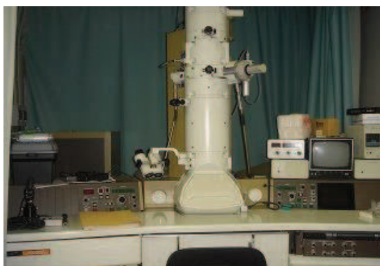
Rycina 25. Transmisyjny mikroskop elektronowy (JEM1200EXII, Jeol, Japonia) Figure 25. Transmission electron microscope (JEM 1200 EX II, Jeol, Japan)
