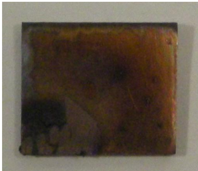
Rys. 32. Powierzchnia próbki tytanowej pokryta powłoką DD 87 po wybarwieniu czerwienią alizarynową
