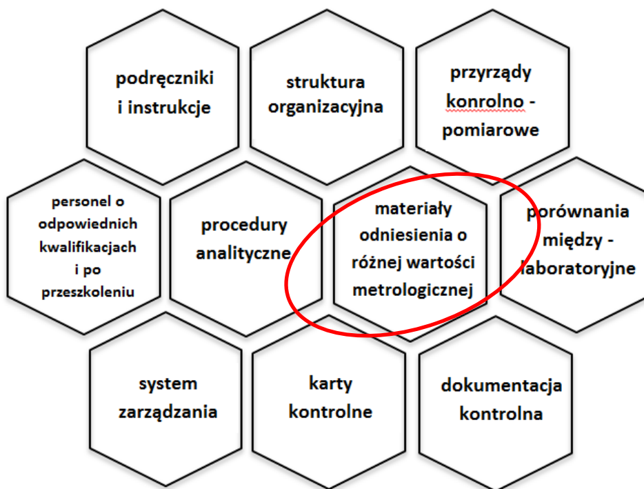
Rys. 4: Elementy systemu kontroli i zapewnienia jakości danych pomiarowych (QA/QC).
