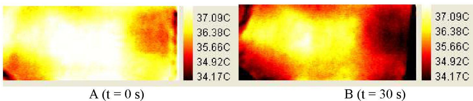
Ryc. 2. Zarejestrowany rozkład temperatur badanej powierzchni. A – w czasie zakończenia działania bodźca grzejącego ( t = 0 s); B – dla t = 30 s, fazy odpowiedzi obiektu
