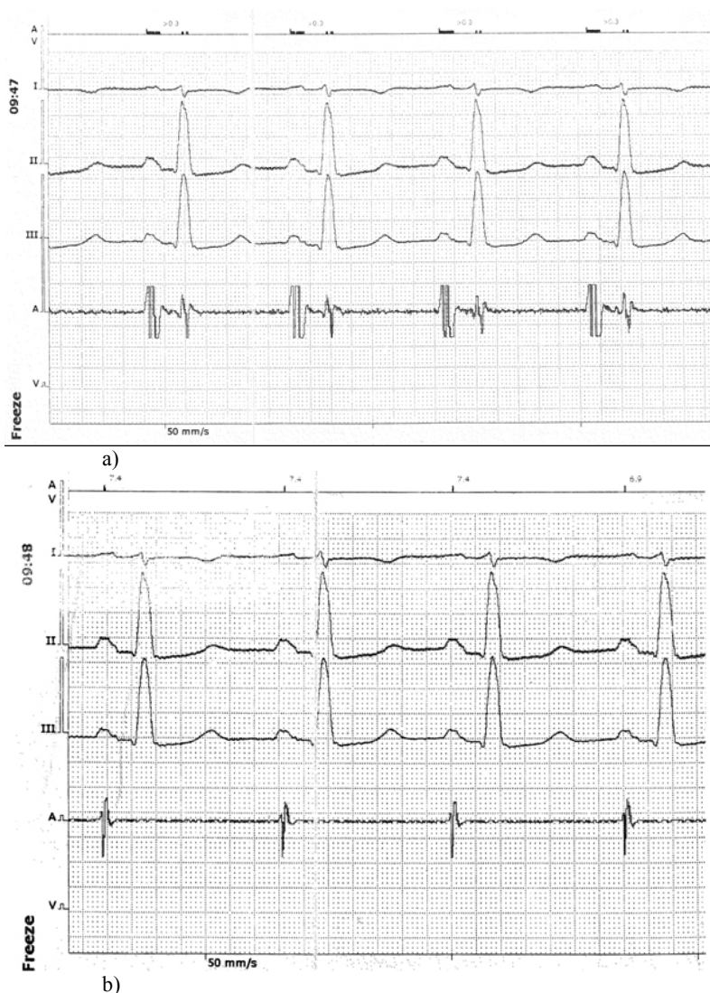
Ryc. 12. Ocena amplitudy sygnałów odpowiadających depolaryzacji komór (FFRSa) rejestrowanych w danym położeniu elektrody prawoprzedsionkowej w czasie automatycznego pomiaru amplitudy fali P. (a) Przy najwyższej zaprogramowanej czułości w konfiguracji BP równej 0,1 mV znacznik Ars w kanale markerów wskazuje na występowanie FFRS; (b) Po zaprogramowaniu czułości 1,5 mV w czasie pomiaru nie stwierdza się FFRS: FFRSa=1,5 mV. A&V – kanał markerów, kanał A – elektrogram z elektrody prawoprzedsionkowej
