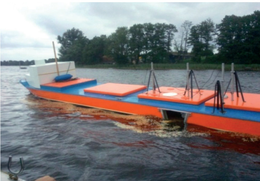
Fot. 1. Ilustracja z badań dotyczących oceny bezpieczeństwa statku w stanie uszkodzonym przy użyciu modelu fizycznego zbiornikowca, jezioro Jeziorak, ława 2011
