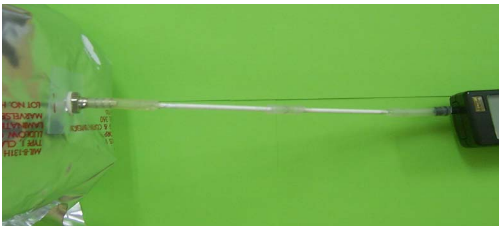
Rysunek 7. Adsorpcja próbki gazowej (spalin) z worka tedlarowego w rurce sorpcyjnej
