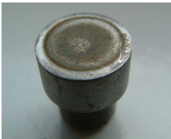
Rys. 5.4. Zdjęcie próbki ze stali węglowej, mające na celu zaprezentować nierównomierną dystrybucję stopnia jej degradacji.
