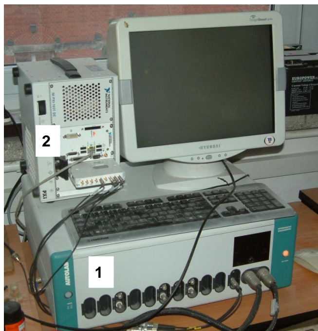
Rys. 8.1. System do pomiarów techniką DEIS w trybie galwanostaticznym: (1) galwanostat Autolab, (2) moduł pomiarowy PXI 1031
