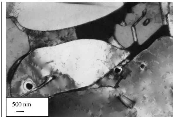
Rys.8.28. Dwufazowy obszar ferrytu i austenitu z wydzieleniami węglików
