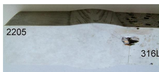
Rys. 8.58. Przekrój poprzeczny próbki 3 po 72 godzinach ekspozycji w roztworze korozyjnym
