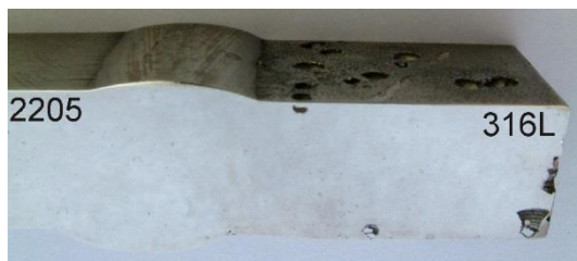
Rys. 8.61. Przekrój poprzeczny próbki 4 po 72 godzinach ekspozycji w roztworze korozyjnym
