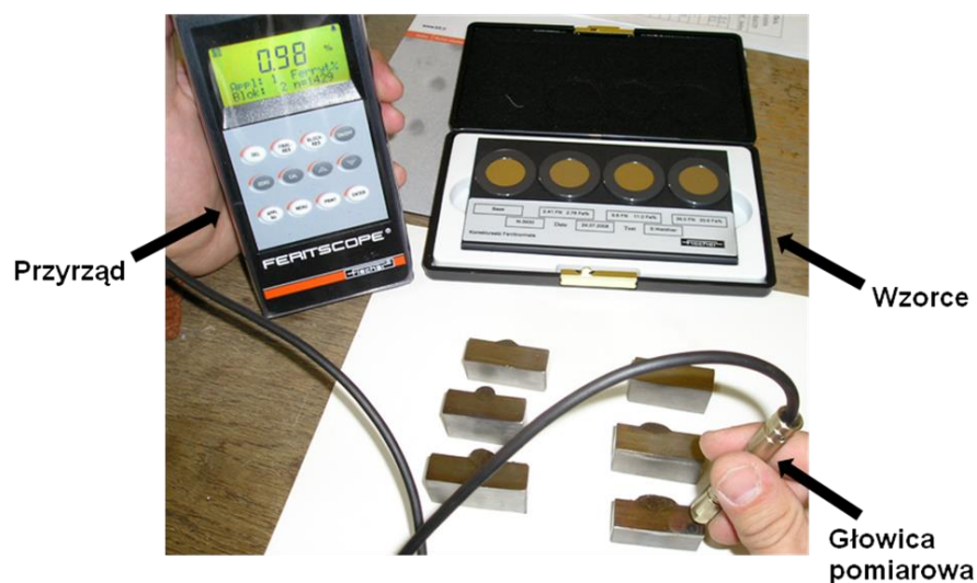
Rys. 7.10. Ferrytoskop Fisher MP30 wykorzystany w badaniach
