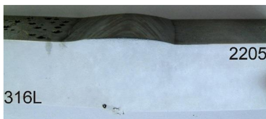
Rys. 8.55. Przekroje poprzeczne złącza nr 2 z widocznymi dużymi wżerami w SWC od strony stali austenitycznej po 72 godzinach ekspozycji w roztworze korozyjnym
