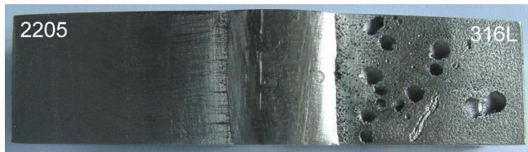
Rys. 8.60. Widok próbki 4 od strony lica (a) oraz grani (b) spoiny po 72 godzinach ekspozycji w roztworze korozyjnym
