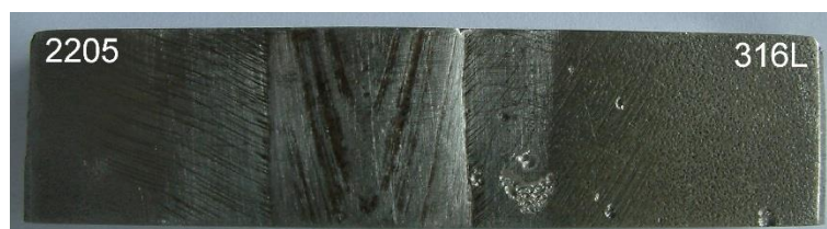
Rys. 8.56. Widok próbki 3 od strony lica (a) oraz grani (b) spoiny po 24 godzinach ekspozycji w roztworze korozyjnym
