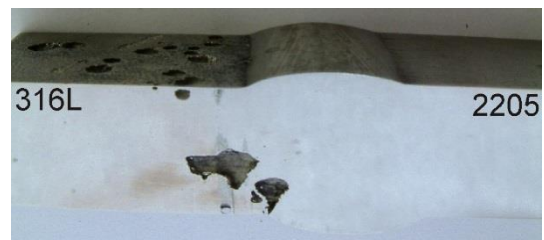
Rys. 8.61. Przekrój poprzeczny próbki 4 po 72 godzinach ekspozycji w roztworze korozyjnym
