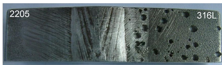
Rys. 8.57. Widok próbki 3 od strony lica (a) oraz grani (b) spoiny po 72 godzinach ekspozycji w roztworze korozyjnym
