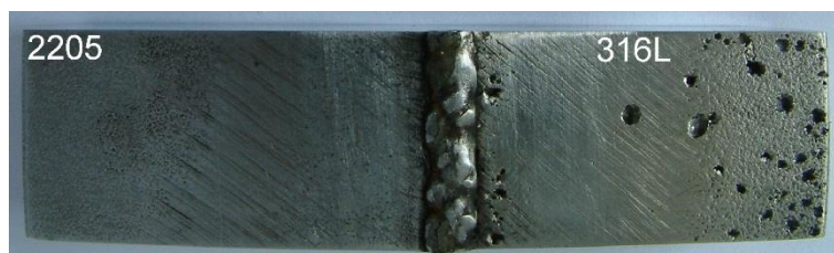
Rys. 8.54. Widok próbki ze złącza nr 2 od strony lica (a) oraz grani (b) spoiny po 72 godzinach ekspozycji w roztworze korozyjnym
