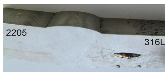
Rys. 8.58. Przekrój poprzeczny próbki 3 po 72 godzinach ekspozycji w roztworze korozyjnym
