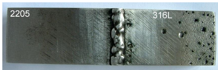
Rys. 8.53. Widok próbki ze złącza 2 od strony lica (a) oraz grani (b) spoiny po 24 godzinach ekspozycji w roztworze korozyjnym
