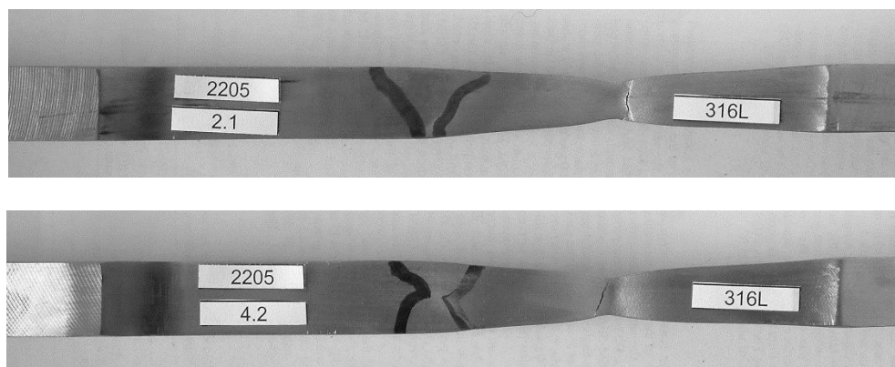
Rys. 8.36. Próbkki nr 2.1 i 4.2 po statycznej próbie rozciągania złączy spawanych
