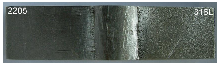
Rys.8.59. Widok próbki 4 od strony lica (a) oraz grani (b) spoiny po 24 godzinach ekspozycji w roztworze korozyjnym
