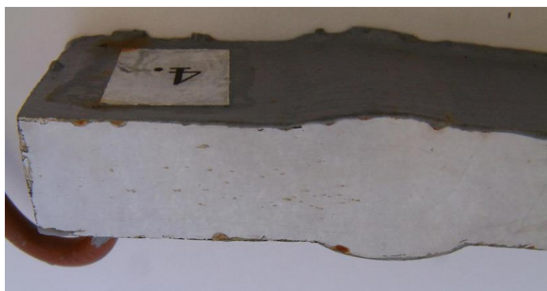
Rys. 8.50. Wżery na powierzchni złącza nr 4 po próbie elektrochemicznej po przekroczeniu potencjału przebicia. Stal austenityczna po lewej stronie złącza
