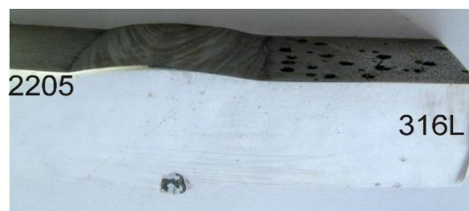
Rys. 8.55. Przekroje poprzeczne złącza nr 2 z widocznymi dużymi wżerami w SWC od strony stali austenitycznej po 72 godzinach ekspozycji w roztworze korozyjnym
