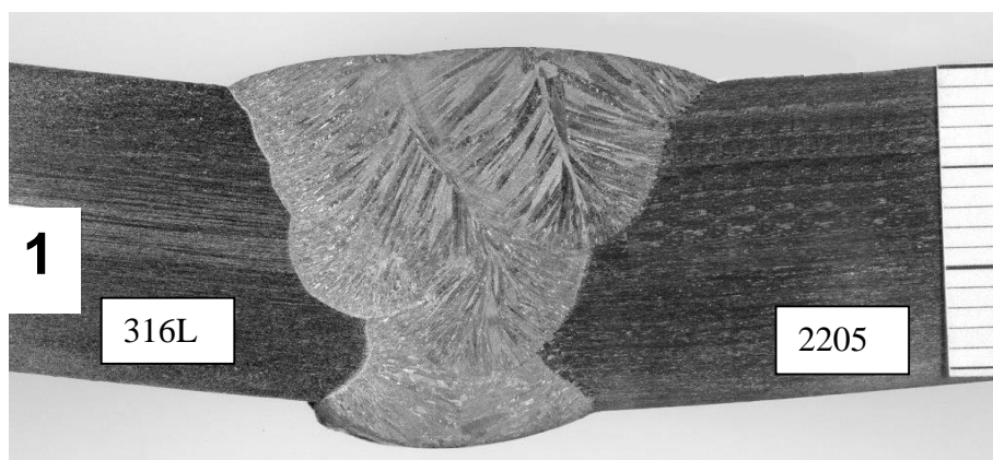
Rys. 8.1. Obraz makroskopowy złącza 1 – typu „Y”
