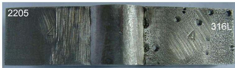
Rys.8.59. Widok próbki 4 od strony lica (a) oraz grani (b) spoiny po 24 godzinach ekspozycji w roztworze korozyjnym
