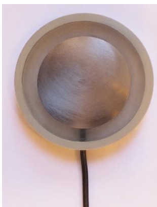
Rys. 29 Elektroda pracująca wykonana ze stali S235JR inkludowanej w żywicy epoksydowej. Powierzchnia pracująca elektrody równa 1 \text{ cm}^2
