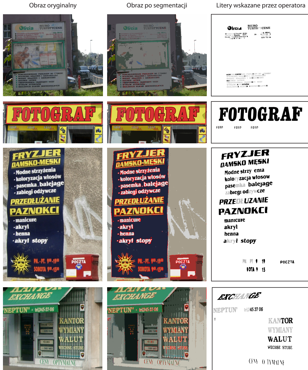
Rysunek 4.1. Przykładowe obrazy źródłowe, obrazy po segmentacji oraz zaznaczone przez operatora segmenty.
