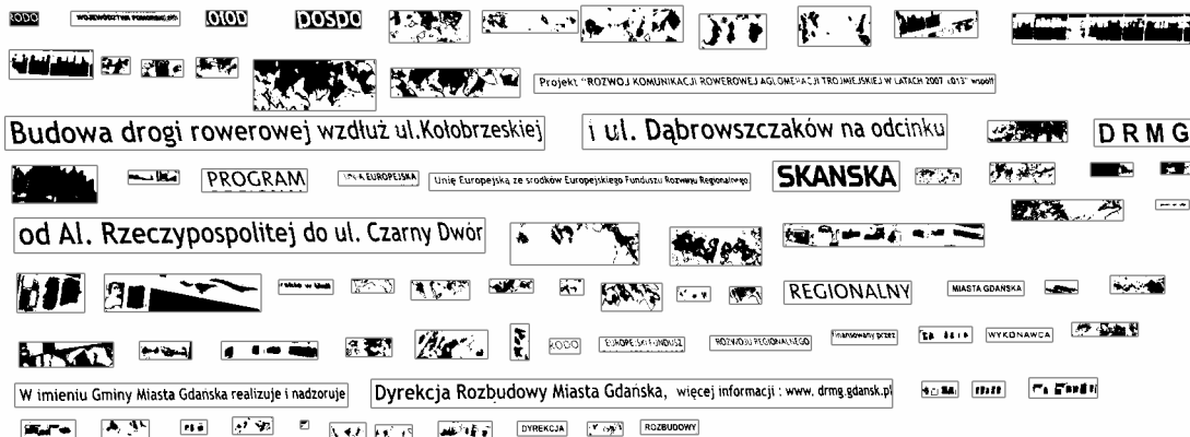
Rysunek 4.26. Przykładowe wyniki algorytmu binaryzacji i korekcji geometrycznej.
