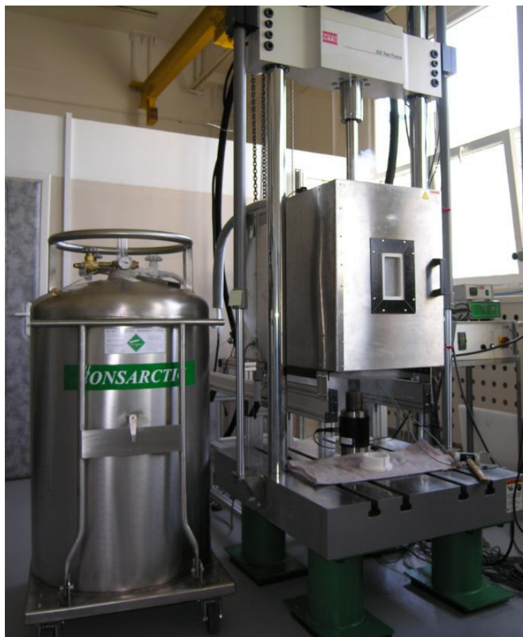
Rys. 20 Stanowisko do badań wytrzymałościowych z komorą temperaturową
