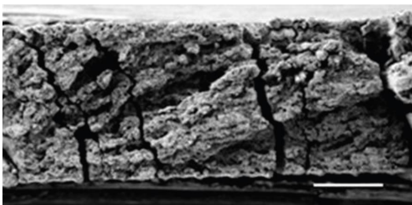
Rys. 5. Powierzchnia przełomu laminatu węglowo-epoksydowego (pow. 50 x) [29].
