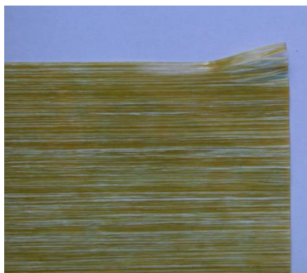
Rys.1. Jednokierunkowa taśma preimpergnowana szklano-epoksydowa (badania własne)
