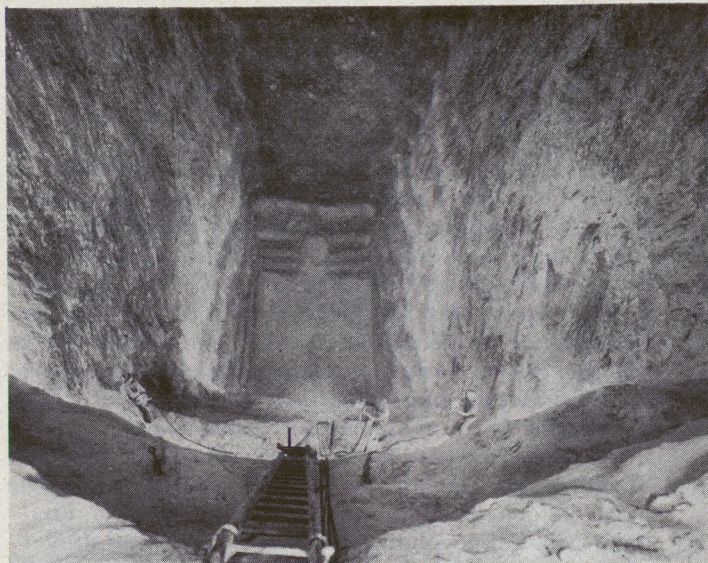
Abb. 8 Das Abbohren der Strossen durch die Häuer im Steilabbau (von oben gesehen)
