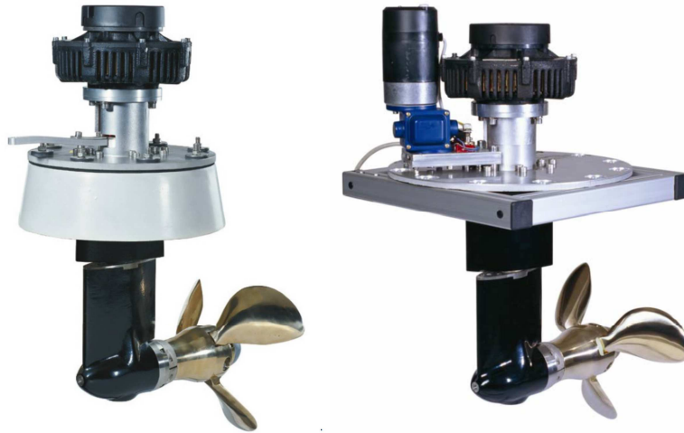
Rys. 2.16. Pędniki z przekładniami typu saildrive z silnikiem elektrycznym szczotkowym prądu stałego o mocy 5 kW obracane wokół pionowej osi manualnie - po lewej lub elektrycznie - po prawej [51].
