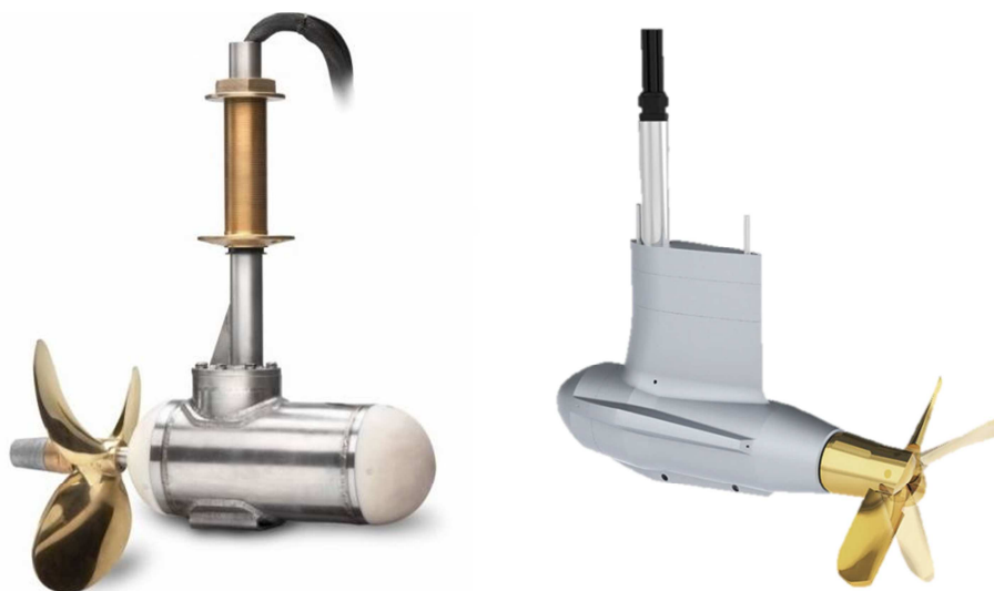
Rys. 2.29. Pędnik gondolowy z silnikiem elektrycznym synchronicznym o mocy 10 kW [37]. Z prawej pędnik gondolowy o mocy 20 kW [55].
