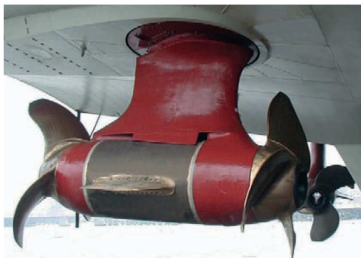
Rys. 2.26. Pędnik gondolowy dwuśrubowy z wałem drążonym. [43]
