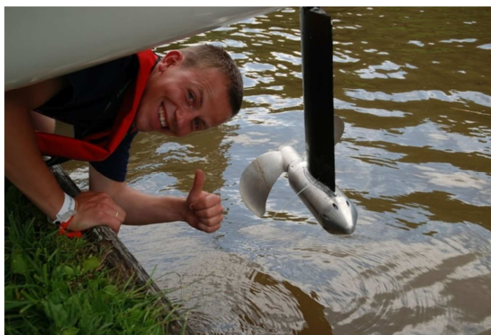
Rys. 2.40. Pędnik gondolowy o mocy 600W po pierwszych testach w warunkach rzeczywistych. Olej wypełniający przestrzeń pędnika doskonale spełnił swoje zadanie odprowadzając ciepło z układu.
