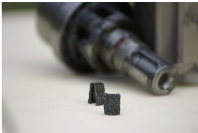
Rys. 2.39. Stan użębienia przekładni planetarnej po udeżeniu śrubą w podwodną przeszkodą dyskwalifikuje ją z dalszej eksploatacji.
