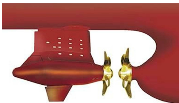
Rys. 2.24. Pędnik gondolowy pracujący w funkcji pędnika przeciwbieżnego. [14]
