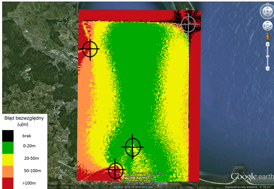
Rys. 4.14. Rozkład obszarowy błędu bezwzględnego \delta_d [m] dla konfiguracji powiększonej, dla szerokości pasma pracy 8 MHz
