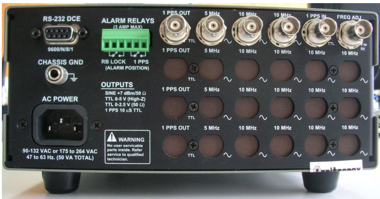
Rys. 5.5. Wygląd rubidowego wzorca częstotliwości – model FS725,
