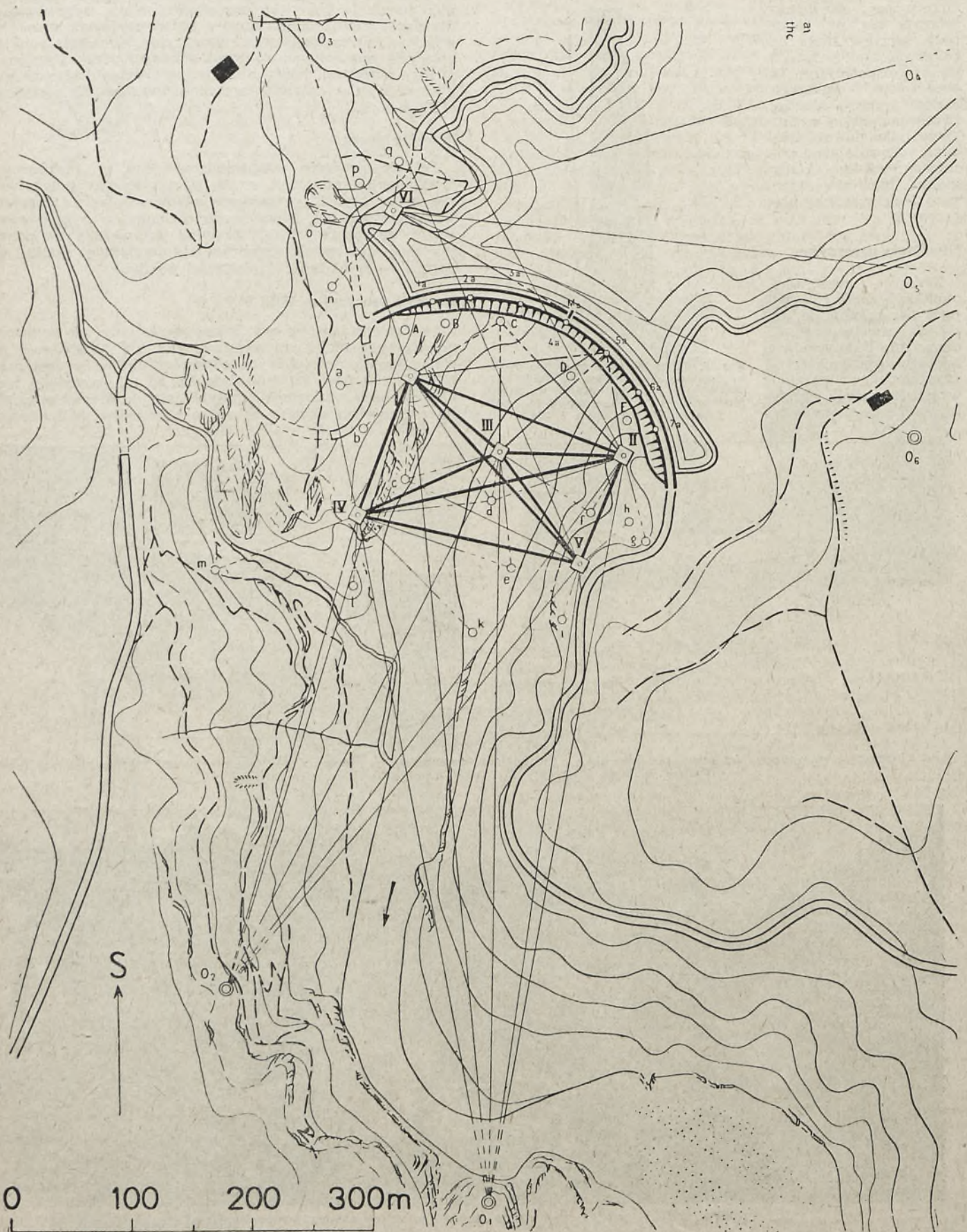
Rys. 14. Plan obserwacji metodą geodezyjną
