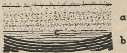
Rys. 88. Przekrój gleby przez a —warstwy przepuszczalne, b —warstwy nieprzepuszczalne, c —wodę gruntową (według Gärtnera).
