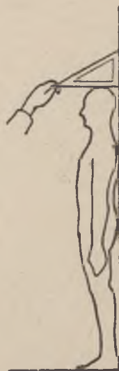
Rys. 301. Pomiar wysokości z pomocą podziałki na ścianie i trójkąta rysunkowego.
