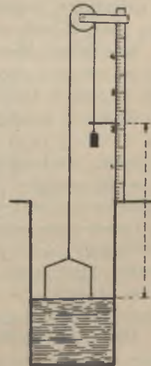
Rys. 89. Przyrząd do określenia wysokości podnoszenia się wody zaskórnej (wędląg Karaffy-Korbulla).
