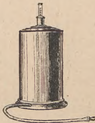
Rys. 306. Spirometr suchy Barnesesa. Przy wdmuchiwaniu doń powietrza podnosimy cylinder wewnętrzny do góry, co wysuwa środkowy słupek z podziałką w górę. Na słupek tym odczytujemy liczbę litrów.
