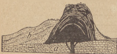
Fig. 17. Schema eines ausgequollenen magmatischen Gesteins: a liegende Sedimentschichten mit Vulkan-schlot; b Tuffaufschüttung.
