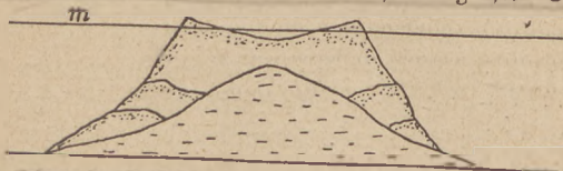
Fig. 40. Schema der Entstehung einer Koralleninsel in drei aufeinanderfolgenden Wachstumsstadien unter entsprechender Absenkung unter den Meeresspiegel m. Gestrichelt: ursprüngliches Ausgangsgestein, das über dem Meeresspiegel lag; punktiert: Korallenoauten, zuerst als Saumriffe, zuletzt als Atoll. (Aus Kahler.)
