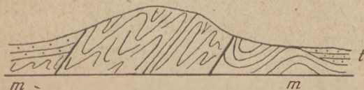
Fig. 65. Schema eines deutschen Mittelgebirges. Gefältelt: alter Gebirgskern, s. T. an Verwerfungen abgesunken und dort von m, t jüngeren Sedimenten bedeckt. (Aus Nahtser.)
