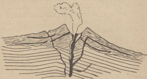
Fig. 16. Schema eines aufgeschichteten Vulkanberges. Unten, breit schraffiert: gewachsene, tektonisch gestörte Gesteinschichten. Oben, eng schraffiert: aufgeschüttete Aschen und Auswürflinge in Kreuzschichtung. Tief schwarz: aufbringende und ausgeflossene Lava. (Nach Heim aus Kahser.)
