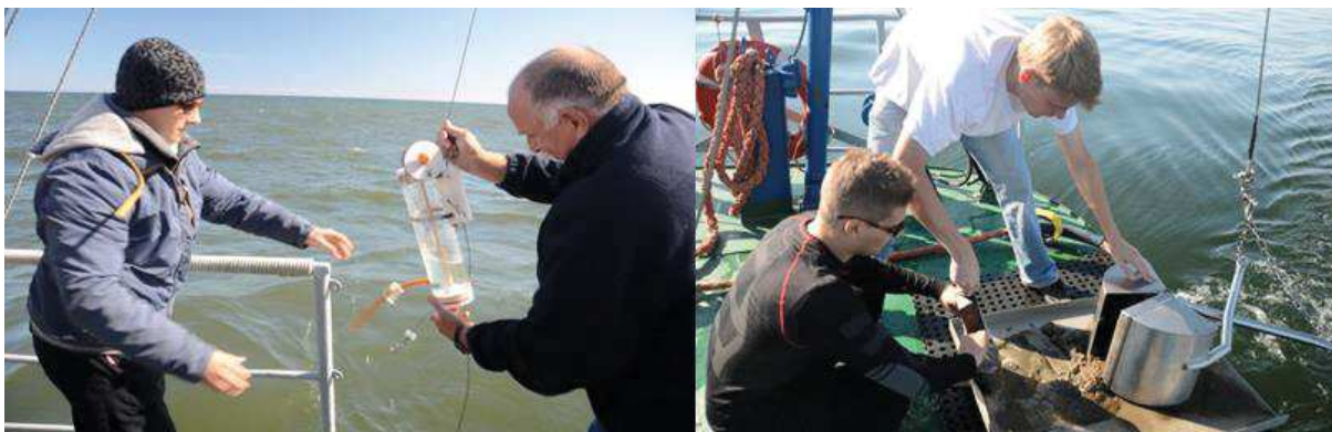
Rys. 39. Po lewej – batometr w trakcie pobierania próbki; po prawej – czerpacz van Veen'a \ (fot. L. Łęczyński)
