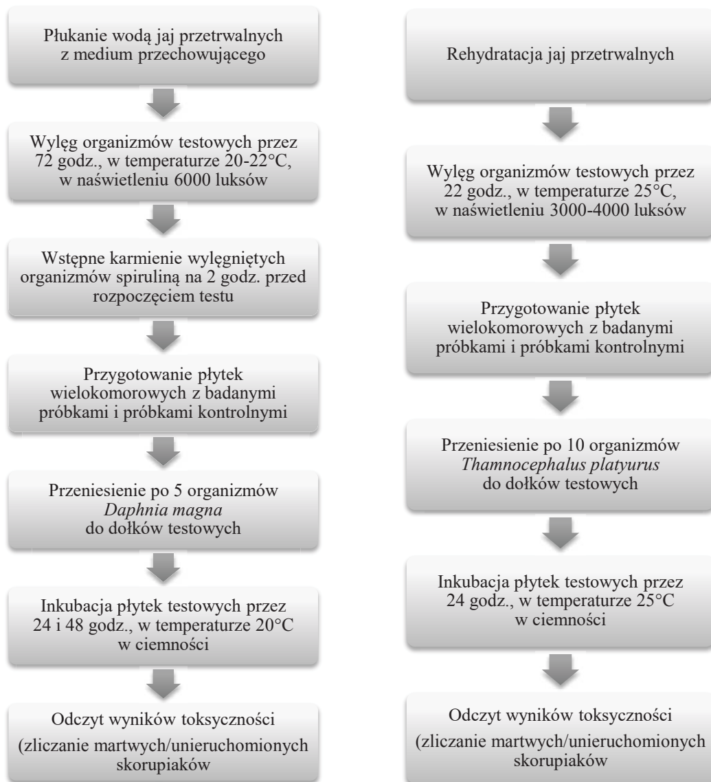
Rys. 18. Schemat procedury pomiaru toksyczności ostrej z wykorzystaniem skorupiaków Daphnia magna (po lewej) oraz Thamnocephalus platyurus (po prawej)
