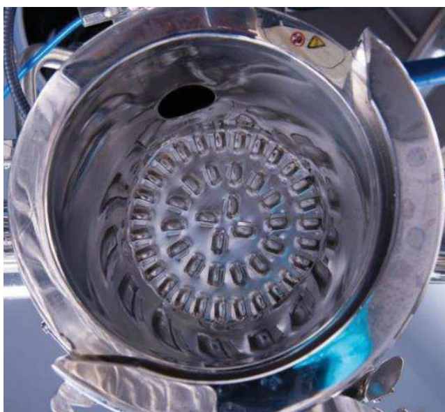
Rycina 17. Dystrybutor powietrza w komorze FlexStream przeznaczony do powlekania i granulacji [31]
