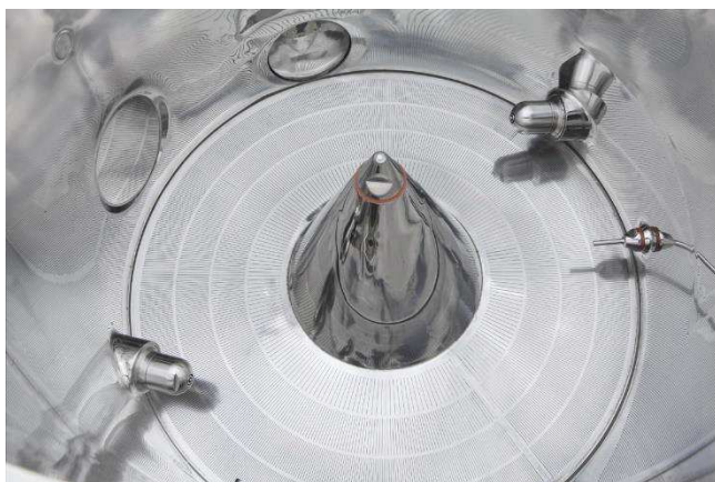
Rycina 16. Dystrybutor w komorze Uni Cone (Bohle) do granulacji i powlekania [30]
