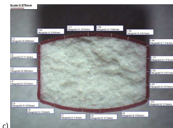
Rycina 52. Przekroje powleczonej minitabletki MT2.5 (a), peletki P0.7 (b) oraz T5.0 (c) wraz z pomiarami grubości filmu na zdjęciach mikroskopowych
