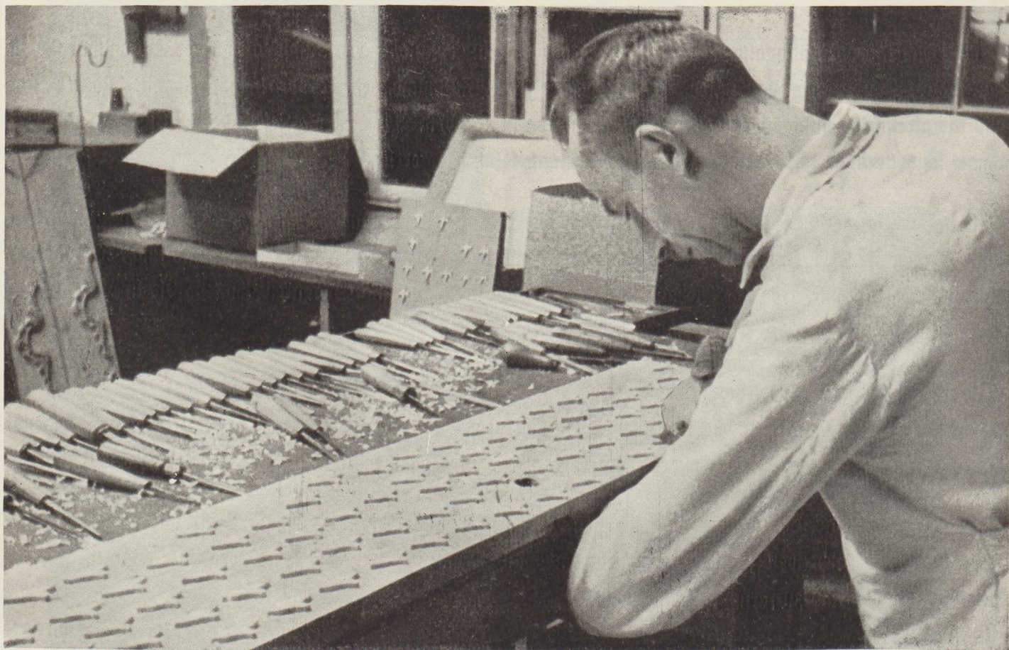
Oben: Aus 7 übereinander liegenden Brettchen werden die Möven roh herausgefägt Unten: Die in rohen Umrissen ausgefägte und dann aufgeklebten Möven erhalten hier naturgetreue Form
