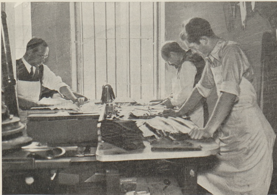
3 Arbeitsgänge: Schaben, Reffen, Zuschneiden des Leders
