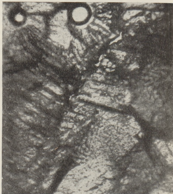
Fig. 6. Temperaturbereich unter 33°. Die zahlreich auftretenden Sprünge lassen eine starke Volumenverringerng erkennen.
