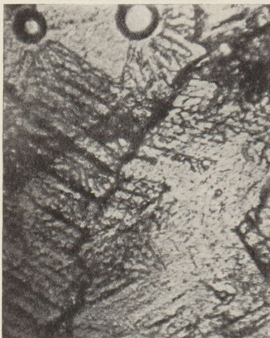
Fig. 5. Temperaturbereich 83° bis 33°. Bei der Umwandlung bei 33° ist eine Volumenvergrößerung festzustellen.
