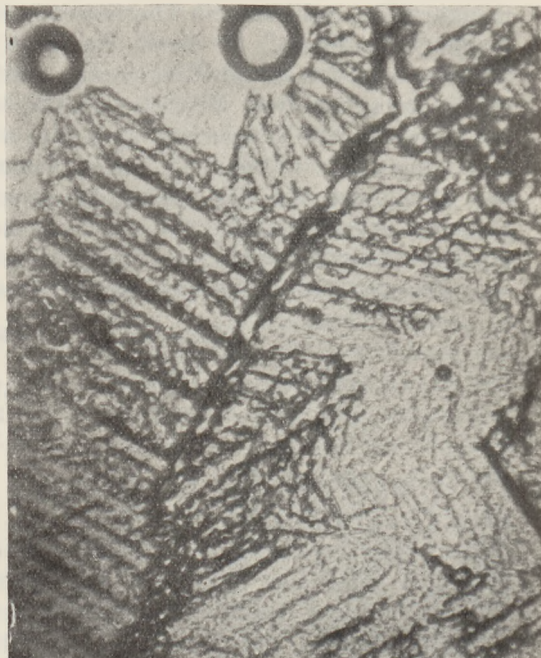
Fig. 4. Temperaturbereich 123° bis 83°. Die bei 123° erfolgte Umwandlung hatte eine an dem Aufreißen des großen Sprunges deutlich sichtbare Volumenverminderung zur Folge.
