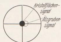
Fig. 5. Lage der Signale der ungeätzten Fläche (schwarz) und der Ätzfläche (punktierter Kreis) im Goniometerfernrohr.
