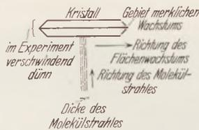
Fig. 10. Wachstum eines Hg-Kristalles (schematisch) nach GROSS und VOLMER im Molekülstrahl.
