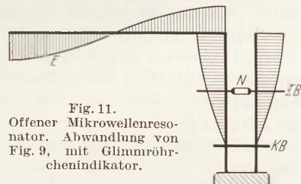
Fig. 11. Offener Mikrowellenresonator. Abwandlung von Fig. 9, mit Glimmröhrchenindikator.
