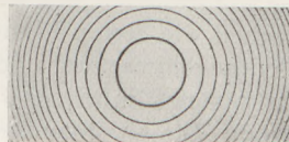
Fig. 4. Blaue Quecksilberlinie. \lambda = 435,8 \text{ m}\mu . Belichtungszeit 60 Sek. b. \frac{18}{10} DIN; etwa 2fache Vergr.
