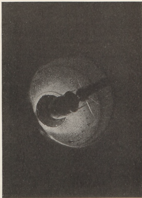
Fig. 2. Natriumschicht mit tropfenförmigen Anhäufungen metallischen Natriums im Inneren einer elektrolysierten Vakuumglühlampe. (Man schaut schräg von der Seite auf die Ansatzstelle des Lampenfußes.)
