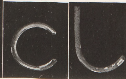
Fig. 14. Rekristallisation von gebogenem und gerade gerichtetem Al-Einkristall.
