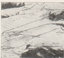
Fig. 7. Deformierte poly- kristalline Struktur. (Nach ADCOCK.)
