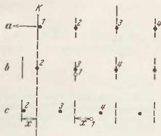
Fig. 1. Lichtstrahl wird in sich selbst zurückgeworfen; Bewegung in Strahlrichtung.
