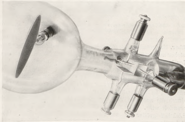
Fig. 3. Plattenpaar mit schräg gestellten Platten zur Entzerrung des bei geneigtem Fluoreszenzschirm eintretenden Aufzeichnungsfehlers.
