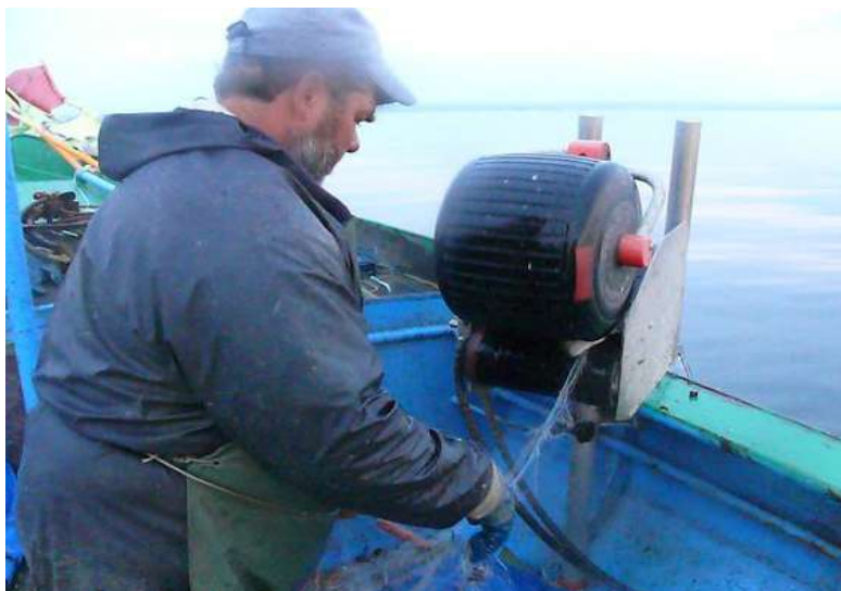
Rys. 14 Wybieranie sieci z wody z użyciem wyciągarki sieciowej
