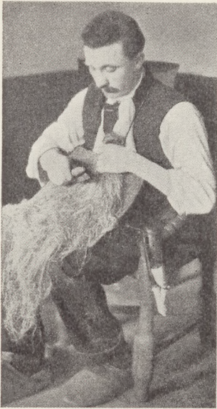
Fig. 8. Linet skaves med skavkniv mot ett läderstycke som underlag. Ravensberg, Westfalen. 20
