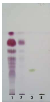
Ryc.47. Chromatogram HPTLC wzorcowej diosgeniny (D) oraz wyciągów organicznych z nasion T. foenum-graecum otrzymanych w aparacie Soxhleta: 1 - wyciąg eterowy, 2 - wyciąg chloroformowy, 3 - wyciąg metanolowy. Faza stacjonarna - HPTLC Si 60 F 254 , faza ruchoma - heptan:octan etylu (7:3, v/v) (F 2 ), detekcja - zmodyfikowany aldehyd anyżowy (temp. 105°C, 5 min).
