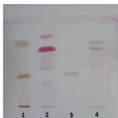
Ryc.58. Chromatogram HPTLC wzorcowej diosgeniny (3) i hydrolizatów (1,2,4) wyciągów organicznych z nasion kozieradki pospolitej, otrzymanych z użyciem aparatu Soxhleta: 1 - hydrolizat SPPChE-H, 2 - hydrolizat SPPE-H, 4 - hydrolizat SPChE-H. Faza stacjonarna HPTLC Si 60 F_{254} , faza ruchoma heptan:octan etylu (7:3, v/v) ( F_2 ), detekcja zmodyfikowany aldehyd anyżowy (temp. 105^{\circ}\text{C} , 1 min).
