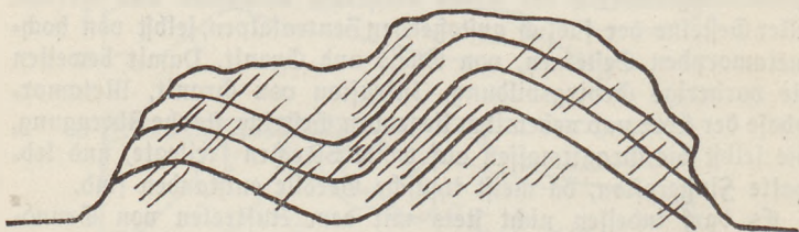
Abb. 44. Schieferung in gefalteten Schichten. Die beste Ausbildung der Schieferung ist dort, wo sie mit der Schichtung gleichläuft
