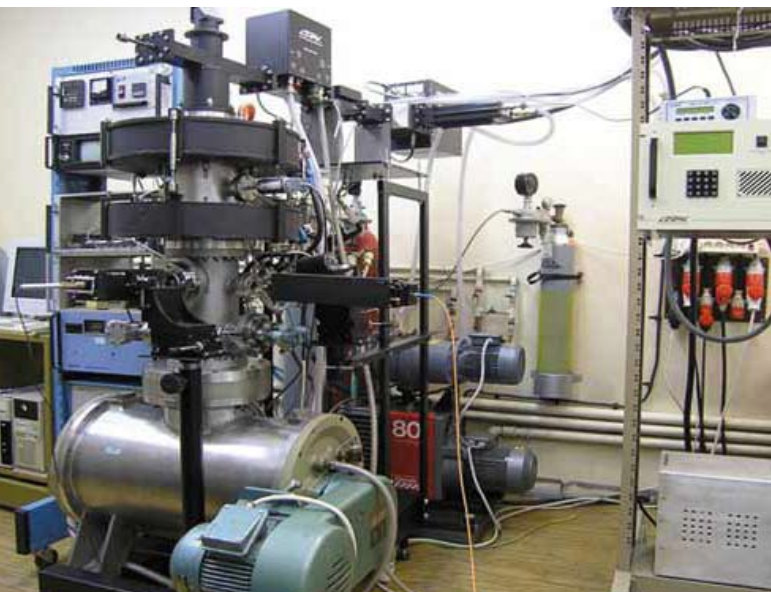
Urządzenie do wytwarzania cienkich struktur węglowych do utwardzania powierzchni układów optycznych, mechanicznych, mechatronicznych (Katedra Optoelektroniki i Systemów Elektronicznych WETI) Fot. Robert Bogdanowicz
