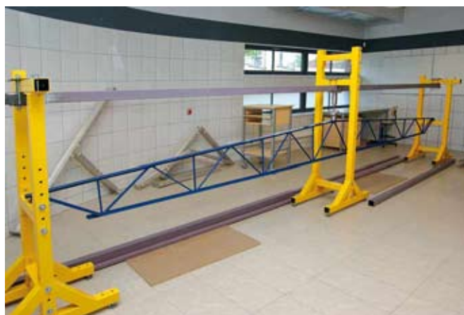
Model dźwigara kratowego przygotowany do badań w budynku Kuźni Fot. Jerzy Bieniek
