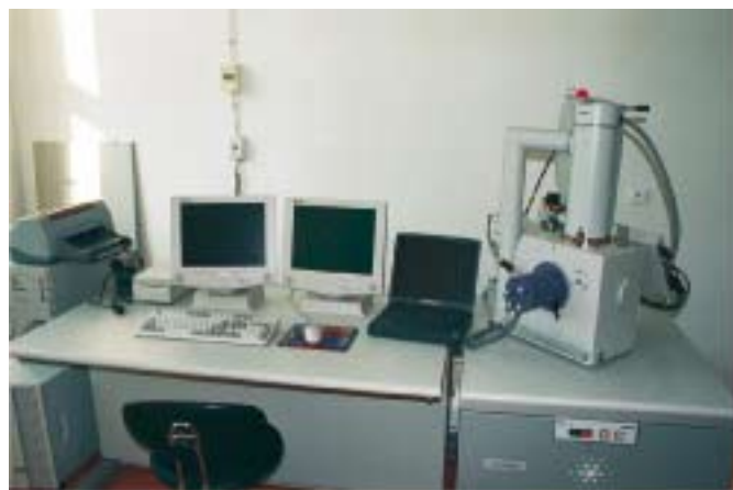
Środowiskowy skaningowy mikroskop elektronowy do badań metali, ceramik, polimerów, preparatów biologicznych (Katedra Inżynierii Materiałowej WM) Fot. Lech Targan
