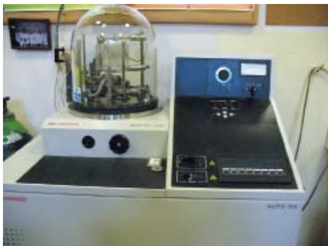
Fot. 2. Próźniowa napyłarka do otrzymywania cienkich nanostruktur molekularnych Fot. I. Kuzborska
