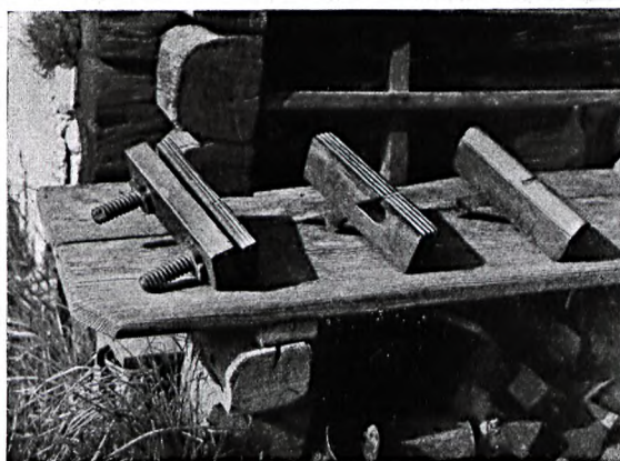
Abb. 61: Profilhobel. Die Schneidekanten der Eisen zeigen die Form des Profiles, welches durch Hobeln gestaltet werden soll. Die Sohle des Kastens schmiegt sich den jeweiligen Profilen folgerichtigerweise aufs engste an. Eine durch Schrauben verstellbare Lehre, die „Stellwand“ (links), dient dazu, das Profil in richtigem Abstand von der Kante und in einer genauen Geraden ausführen zu können.
