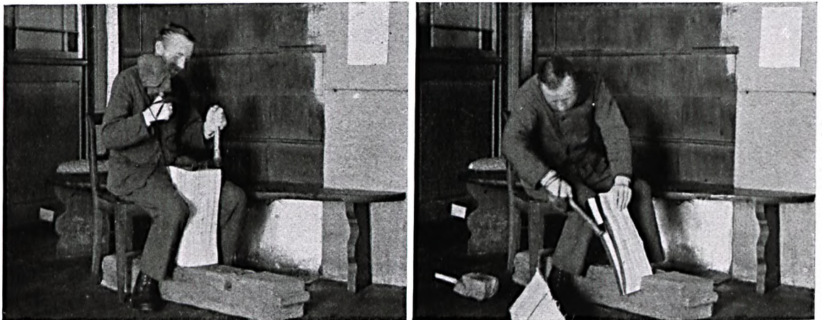
Abb. 2 und 3: Schwarzwälder Schindelspalter bei der Arbeit. Das Holz wird anpassend an den Spiegel in einer vom Mark (Mittelpunkt) nach der Rinde zu gehenden Ebene zuerst mit dem Beil in Klötze, dann mit der Spaltklamm und dem Schlägel (2) unter Zuhilfenahme des Schindelklotzes (3) in Teilstücke, bis die Schindelstärke erreicht ist, gespalten. In dieser Richtung, in der die Spaltklamm gleich einem eingetriebenen Keil wirkt, lassen sich die Längsfasern am leichtesten voneinander trennen.
