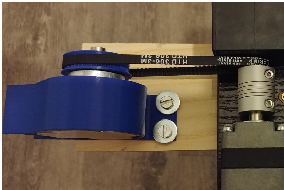
Rys. 5.13. Połączenie enkodera z wałem suwnicy
