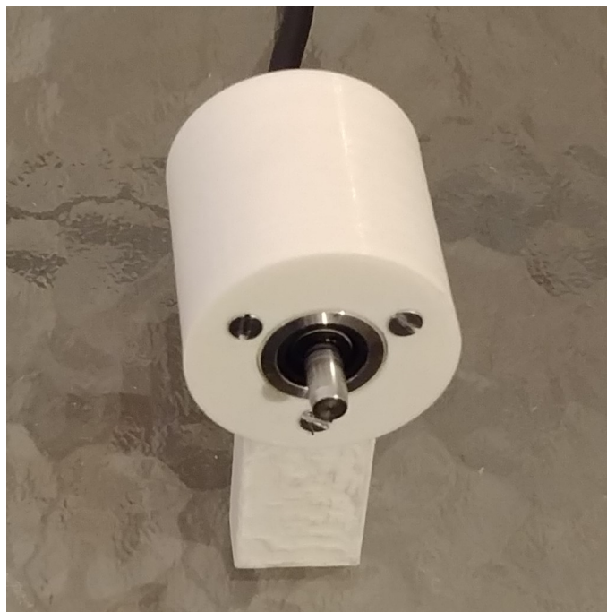
Rys. 5.5. Mocowanie enkodera umieszczonego na ramieniu
