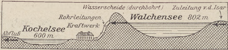
Abb. 2, § 211. Erläuterungsschnitt zum Walchenseekraftwerk (vgl. Abb. 2, § 211).
